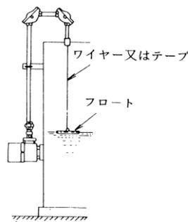
浮子式計量装置の例
