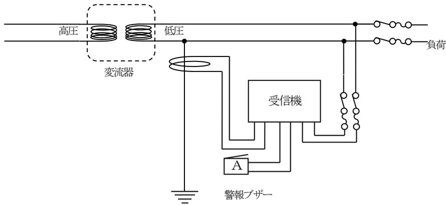
単相3線式変圧器の接地線に設ける場合
