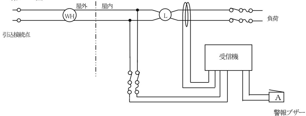
例3 変圧器のB種接地線に設ける方式の設置例
