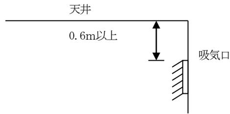
オ ア及びイにより吸気口付近に設ける場合は、吸気口から1.5m以内で、かつ、燃焼器等から漏れたガスを有効に検知できる方向に設けること。
