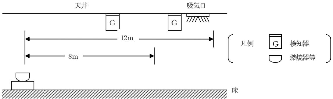
イ 燃烧器から水平距離8m以内に吸気口がある場合は、当該吸気口付近に設けることができる（第25-11図参照）。
