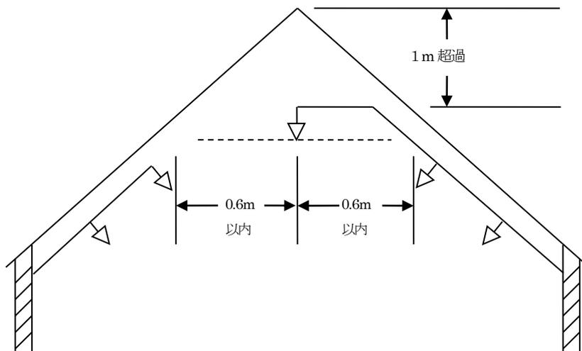
エ はり、たれ壁等がある場合のヘッドの配置は、第14-5図又は第14-3表の例によること。ただし、同図H1及びDの値は、ヘッドからの散水が妨げられる部分が他のヘッドにより有効に警戒される場合は、この限りでない。
