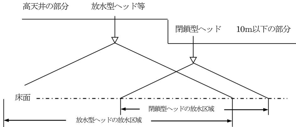
b 境界部分にたれ壁等を設けるなど、それぞれの部分に設置されたスプリンクラーヘッドの感知障害、誤作動等を防止するための措置を講じること。
