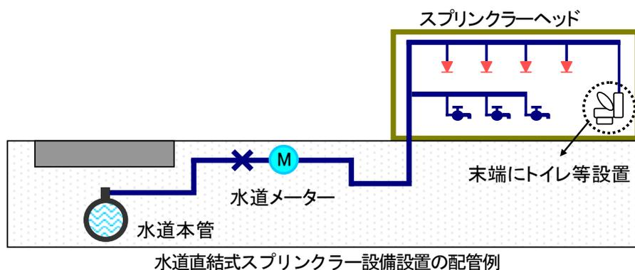
(5) 水道直結式スプリンクラー設備に用いる配管、管継手及びバルブ類は、「特定施設水道連結型スプリンクラー設備に係る配管、管継手及びバルブ類の基準（平成20年12月26日消防庁告示第27号）」及び、水道法第16条「給水装置の構造及び材質の基準」に適合する構造とし、ライニング処理等がなされたものについては、当該規格に適合する配管等と同等以上の強度、耐食性及び耐熱性を有するものとして取り扱うこととする。ただし、火災時に熱を受けるおそれのない部分（壁又は天井
