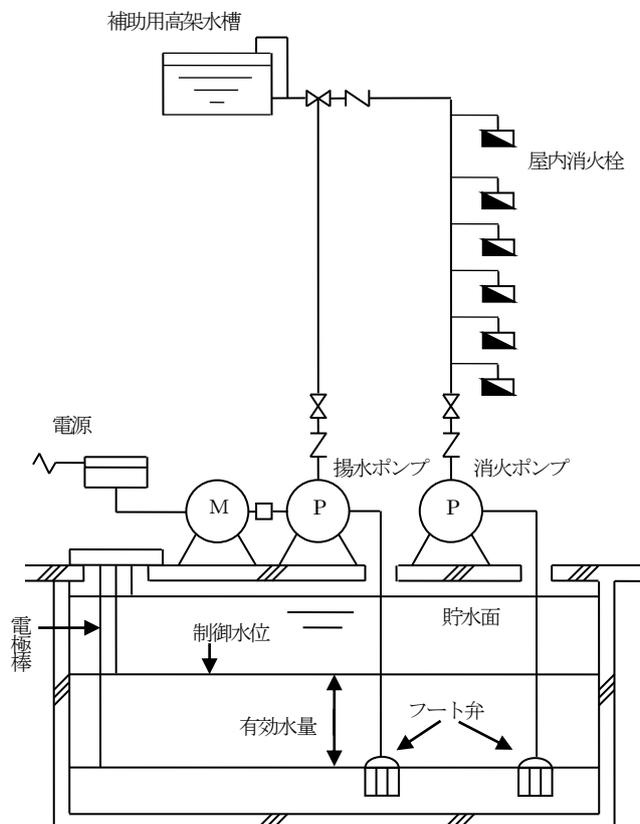
イ 加圧送水装置にポンプを用いる場合は、屋内消火栓設備のポンプのフート弁の上部に他のポンプのフート弁を設け、その間の水量を有効水量とすること（第13-8図参照）。
