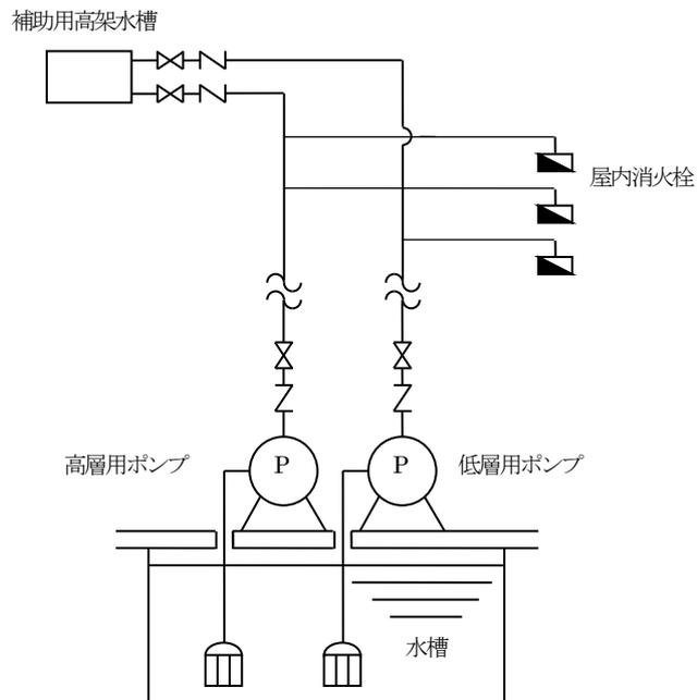
ウ 中継ポンプを設ける方法 (第13-4図参照)
