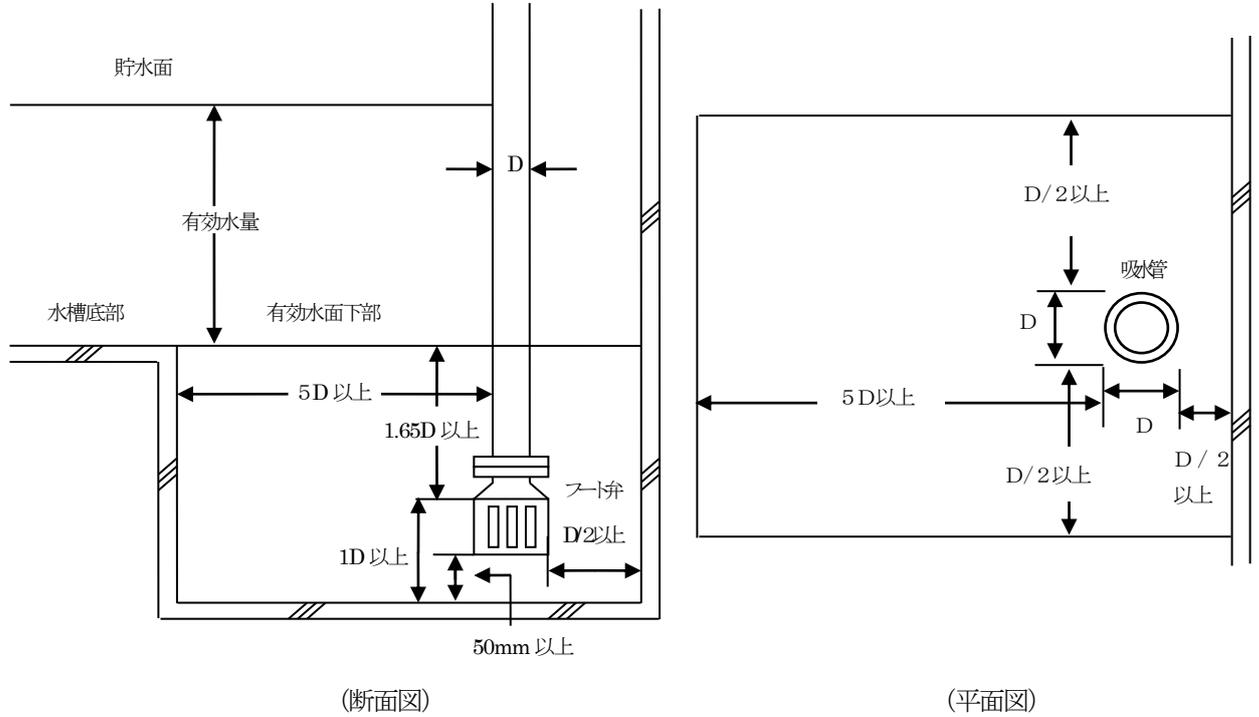
第13-5-2図 (地下又は床下水槽を用いサクシヨンピットを設けない場合又は連通管を設ける場合)
