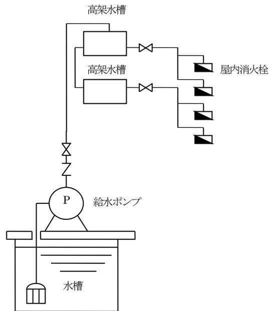
イ 配管系統を別にする方法 (第13-3図参照)
