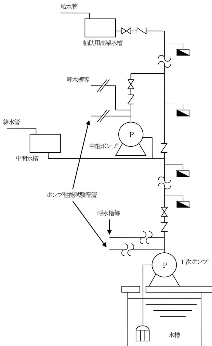
エ 減圧機構を有する消火栓開閉弁を設ける方法
